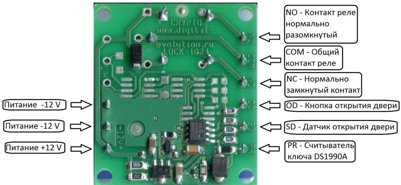
Схема подключения контроллера MagLock-63-24SW240 с электромагнитным замком VISIT-ML400
