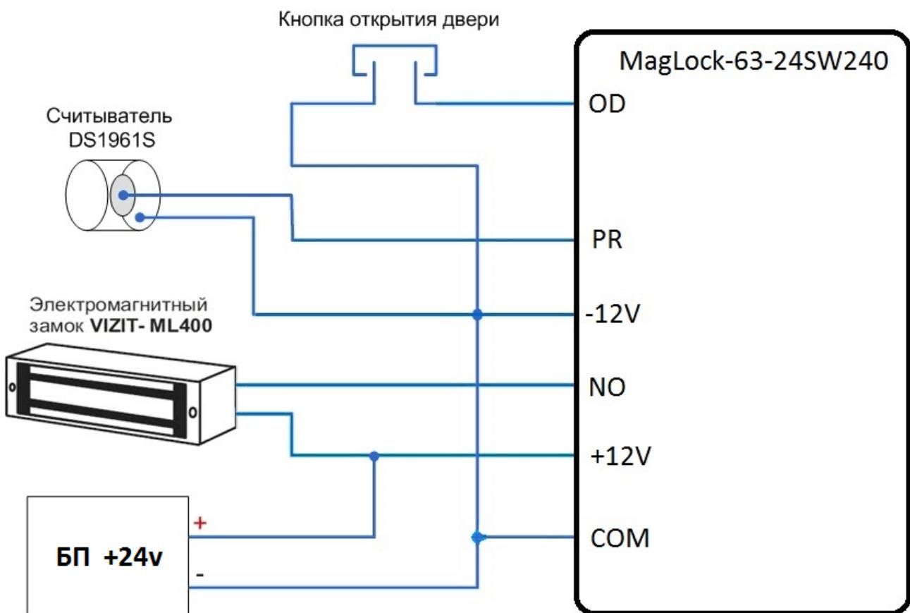
Схема подключения контроллера MagLock-63-24SW240
